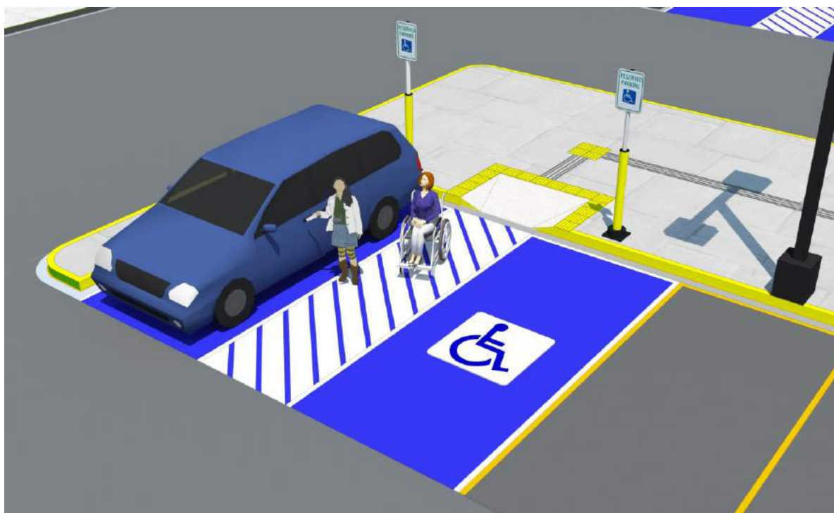
FIGURA 12. Ejemplo ilustrativo de bandas podotáctiles en estacionamientos
